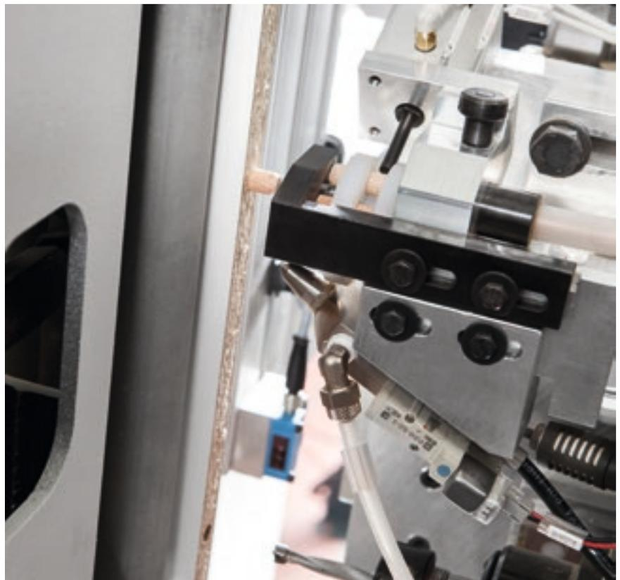
Grupo para perforación contrapuesta que permite completar los mecanizados en la cara trasera del panel.
